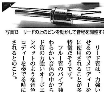
写真13 リードの上のピンを動かして音程を調整する
