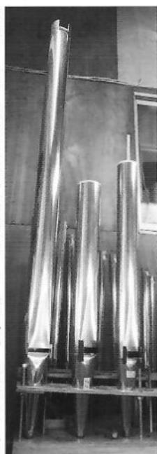
写真4 左から開管、閉管、半閉管のフルーパイプ。3本とも音程は同じ
