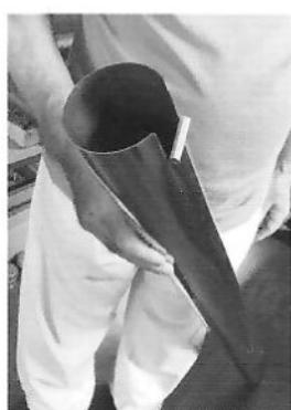
写真6 開管の先端を加工して調律をしやすくするフルー管のパイプ
