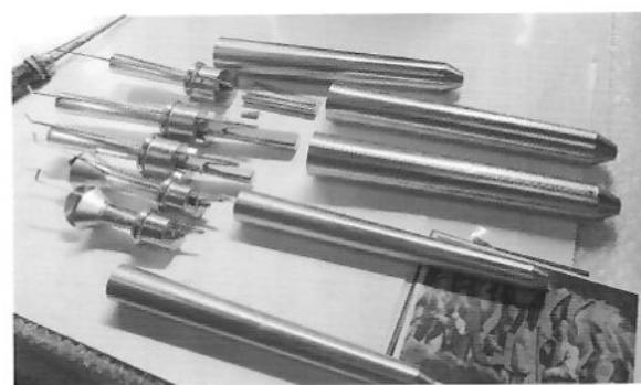
写真9 リード管のカバーを外し、リードの部分が見える。リードの長さで音程が異なる。縦になっているのを横に置いて撮影。右(下)からパイプに空気が送られる。
